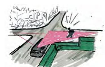
Exemple avec cône de visibilité
